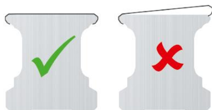
Obr. 5.45: Správně a nesprávně nasazený krycí pásek
